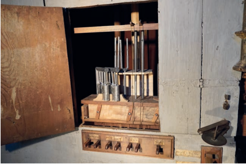
Dispositivo degli accessori (Rossignuolo, Grillo primo e secondo, Speranza, Passere) ricostruito da Bartolomeo Formentelli
